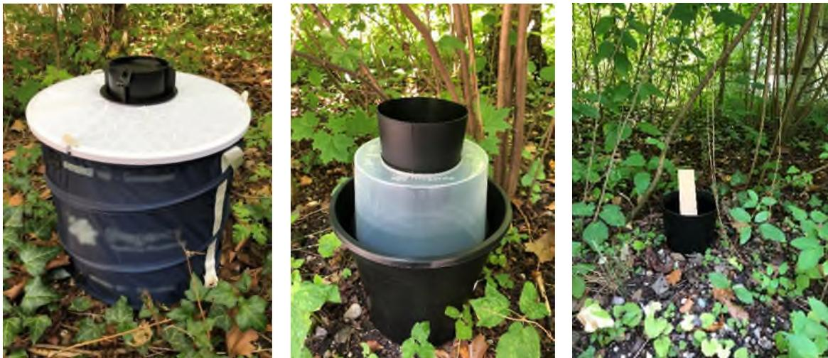
**Abb. 1.1:** Verschiedene Typen von Stechmückenfallen (von links nach rechts: Sentinel-Fallen, GAT-Fallen und Ovitrap) (Quelle: LGL)
